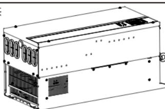
步骤2: 拆卸底部线缆进口钣金及固定螺钉
