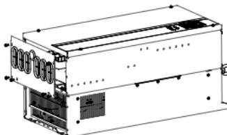
步骤3: 将橡胶件从底部钣金上移到底座
