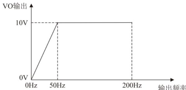
如果C06.73 = 50.00% (100Hz)，C06.74 = 10.00% (20Hz)，则变频器输出频率和VO输出电压的关系如下图所示：
