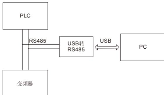
Modbus调试系统连线图
