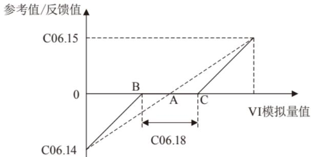
未设置零点死区前, A点为对应参考值/反馈值为零的VI点; 设置零点死区后, AB = AC = C06.18/2, 当VI输入值为BC之间时, 对应的参考值/反馈值均为零。
