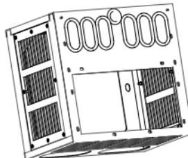
步骤4: 用M5 × 12 的螺钉固定底座和变频器
