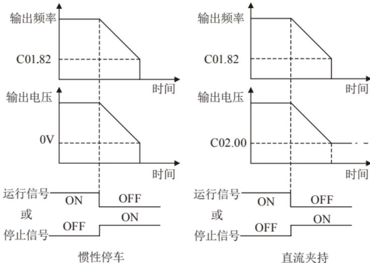
注意：停止功能最低启用频率大于或等于直流制动切入频率时，停止功能起作用；如果停止功能最低启用频率小于直流制动切入频率时，直流制动起作用。
